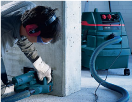
Abb. 14 Mauernutfräse mit Staubabsaugung
