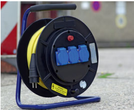
Abb. 11 Geeigneter Leitungsroller für den Einsatz auf Bau- und Montagestellen mit isoliertem Griff und Trommel aus Isolierstoff
