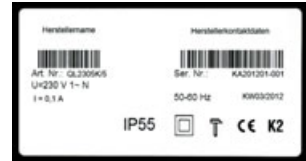
Abb. 16 Typschild einer Handleuchte mit notwendigen Angaben
