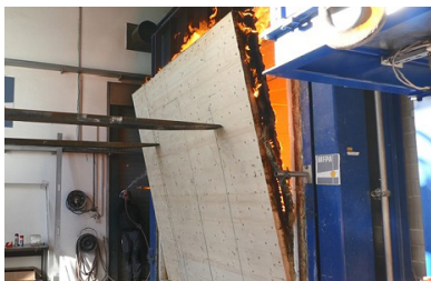
Abb. 1b: Abbrandexperiment bei einseitiger Brandbeaufschlagung
