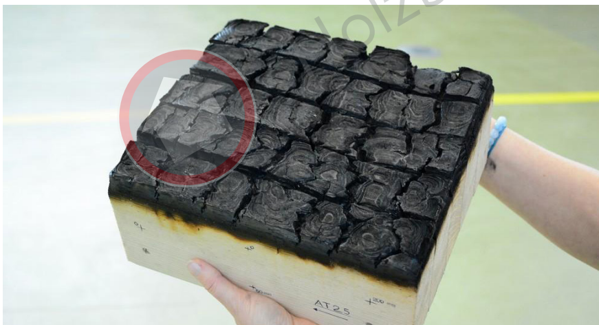
Abb. 1a: Abbrandexperiment bei einseitiger Brandbeaufschlagung
